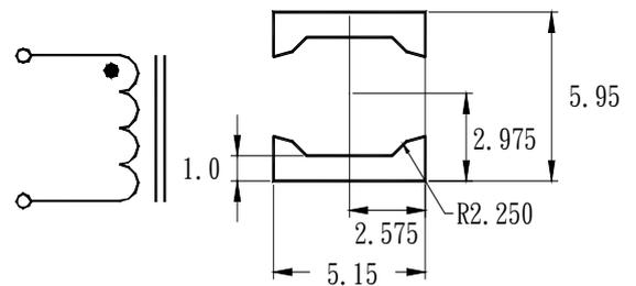
A=5.30m/m MAX ; B=5.30m/m MAX ; C=1.80m/m MAX ; MARKING= Inductance value
